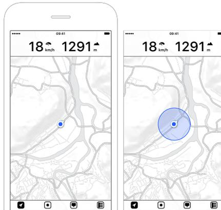
Abbildung 2.5: Positionsanzeige mit Richtungspfeil – Genauigkeitsanzeige am Standort
