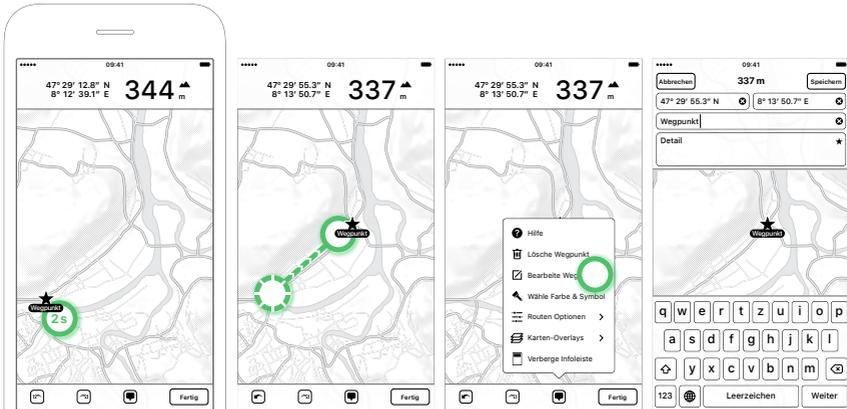
Abbildung 2.17: Hinzufügen eines neuen Wegpunktes durch längeres Antippen > 2 Sek. – Verschiebe den Wegpunkt durch Ziehen über die Karte – Ändern des Namens oder Details des Wegpunktes – Eingeben der exakten Koordinaten oder Titel- und Detailinformationen
